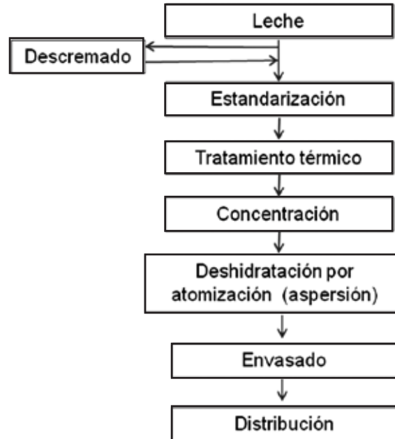
Figura 4. Producción de leche descremada en polvo.
